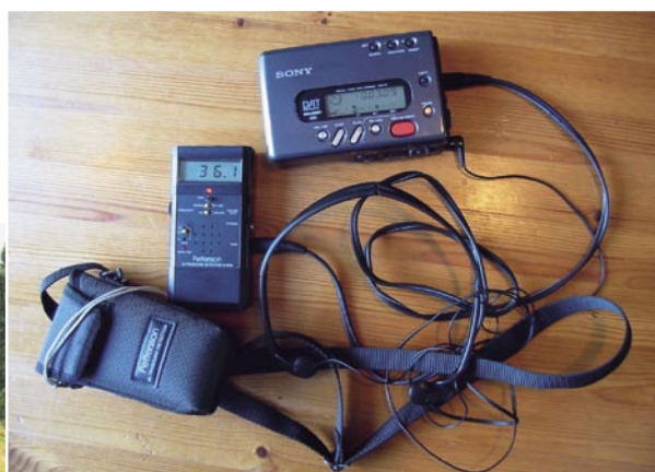
De vleermuisdetector is een van de belangrijkste instrumenten voor inventarisatie van vleermuizen.
