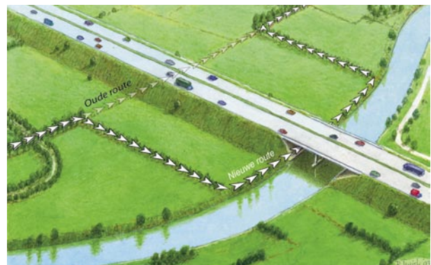
Een ruime overspanning van water met een brug biedt vleermuizen goede mogelijkheden om veilig onder de weg door te vliegen. Oude geleidende structuren kunnen naar zo'n punt omgeleid worden.
